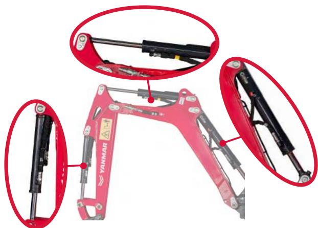
Cilinders boven de giek gemonteerd
