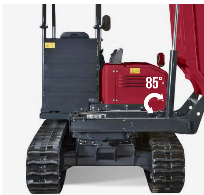
DRAAIWAGEN DIE 180° KAN DRAAIEN
